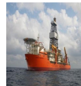
海洋掘削船 (ドリルシップ) 油田・天然ガス田の探査掘削などを目的とした浮体式海洋掘削装置の一種。
